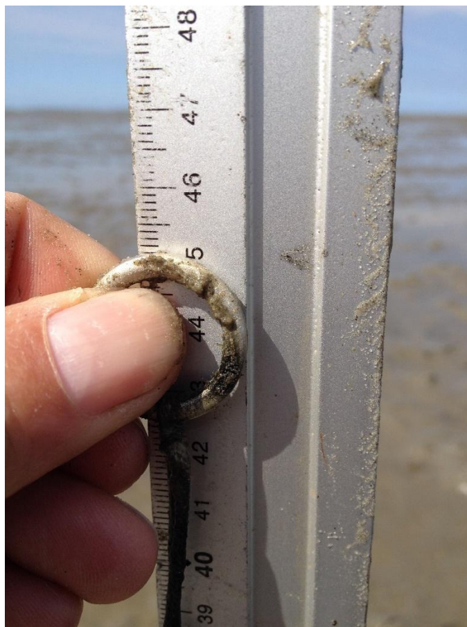
Figuur 5. Meetliniaal met meetvoet. Deze wordt steeds op dezelfde wijze op de bodem gezet waarna de lengte van het meettouw langs de schaal wordt afgelezen. In dit geval 45,1 cm.
