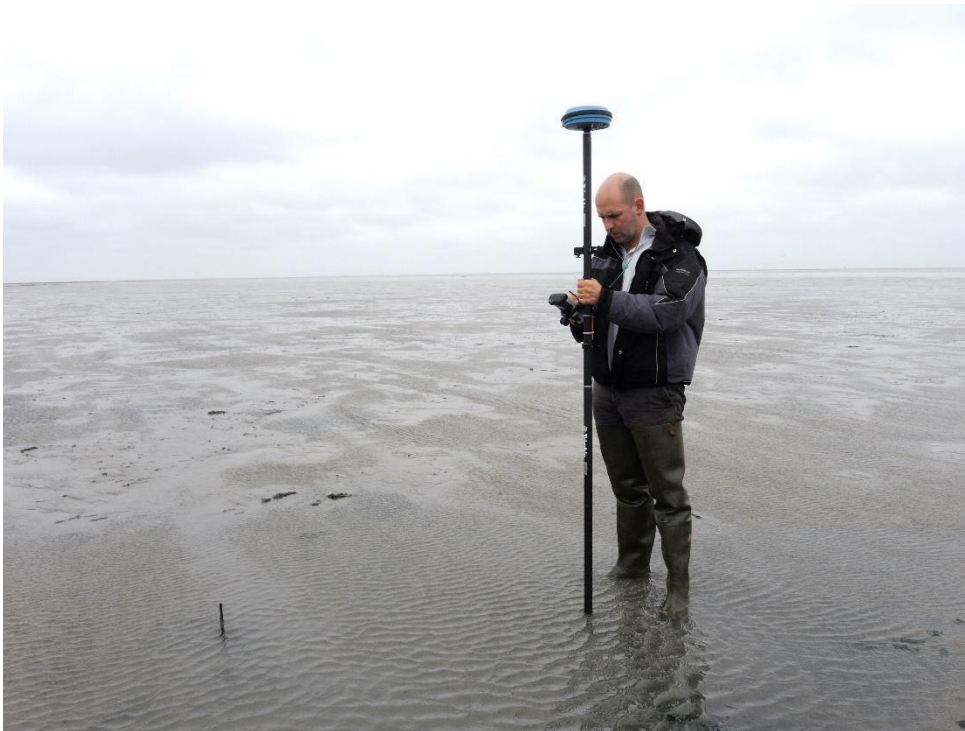
Figuur 28. Met DGPS inmeten van station P140 op het wad bij Paesens. Aan de onderkant van de staf is een rooster gemonteerd dat perfect op de wadbodem aansluit en niet wegzakt. De hoogte is ingemeten op de plaats waar het meetouw recht boven het grondanker uit de bodem komt. 2 september 2013. Foto J. Krol.
