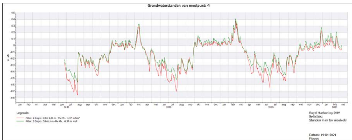
Afbeelding 7.3-1: Verdrogingsmeetpunt in het Natura 2000-gebied Van Oordt's Mersken, Koningsdiep. Bij dit meetpunt wordt op twee verschillende dieptes de grondwaterstand (stijghoogtes) gemeten.
