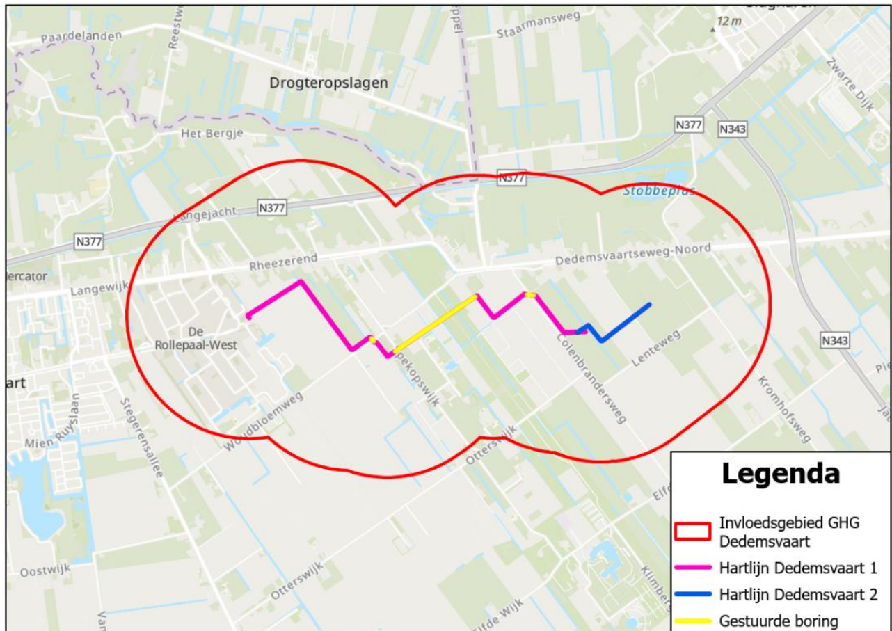
Figuur 4.12 | Maximale verlagingcontouren tracéalternatieven A – paars en A – blauw van deelproject 3
