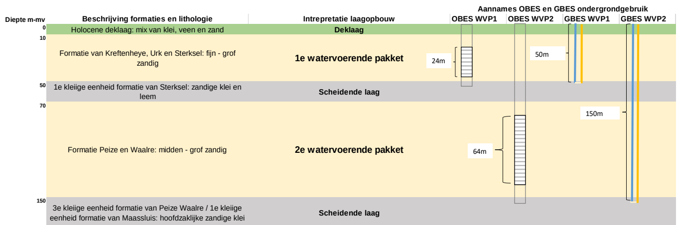
Figuur 6-1 Versimpelde laagopbouw van de ondergrond in Utrecht, gebruikt voor de aannames voor de effectieve dikte van WVP 1 (24m) en WVP2 (64m) voor OBES, en voor de totale diepte van GBES tot de onderkant van WVP1 (50m) of WVP2 (150m).
