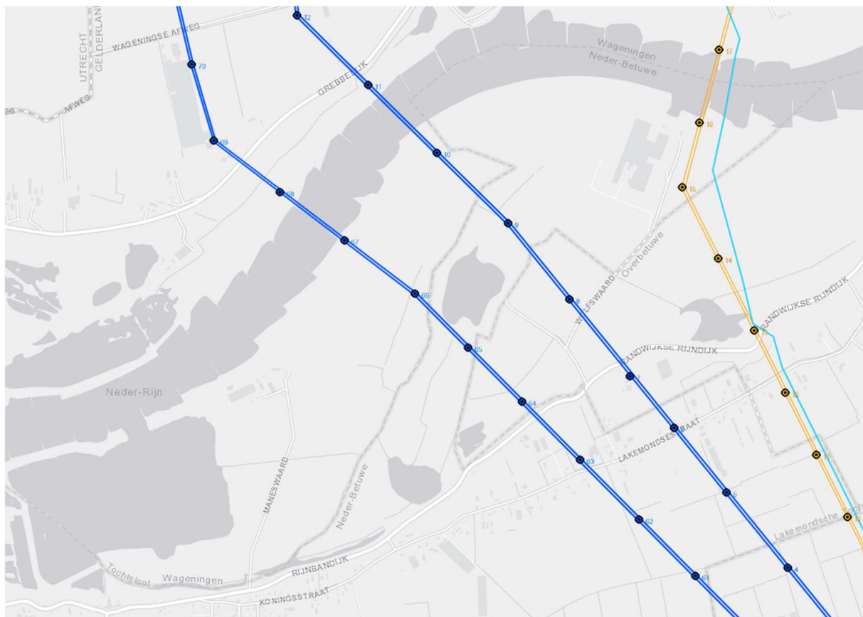
Figuur 6: Hoogspanningsnet, in het blauw de verbindingen 150 kV Veenendaal - t Goede Spoor - Dodewaard (zuidwest) en 150 kV Dodewaard - Ede (noordoost) (bron: https://webkaart.hoogspanningsnet.com )
