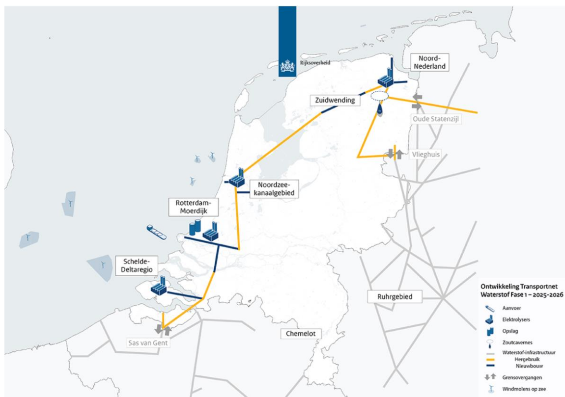
Afbeelding 6.1. Fase 1 Waterstof Netwerk Nederland. Afbeelding uit kamerbrief 'Ontwikkeling transportnet voor waterstof'
