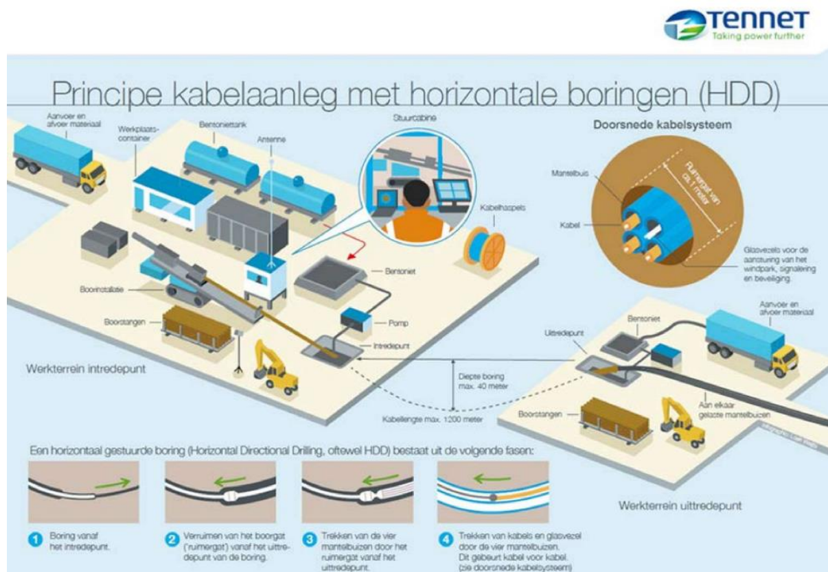
Figuur 8. Situatieschets intredepunt HDD-boring (bron: Tennen TSO).
