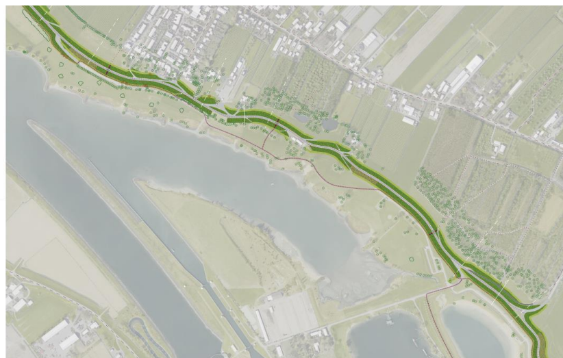
Figuur 3-8 Dijkontwerp dijkvak 3 (dijkvak 3a, 3b, 3c, 3d, 3e)
