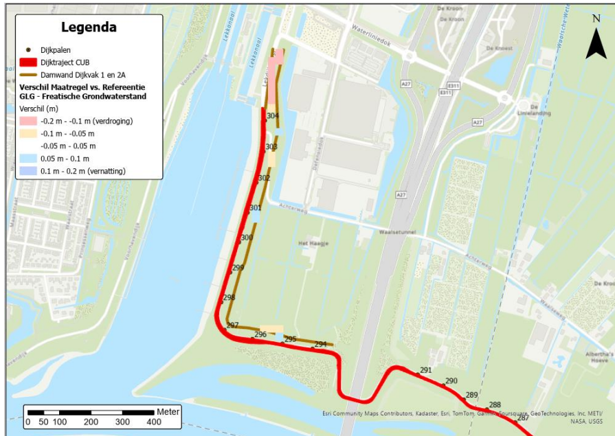
Figuur 6-5 Berekend effect van de damwanden in dijkvakken 1 en 2a op de freatische grondwaterstand GLG
