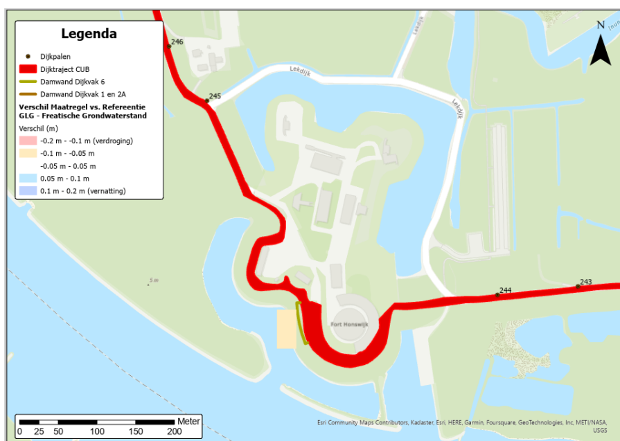
Figuur 6-6 Berekend effect van de damwanden in dijkvak 6 op de freatische grondwaterstand GLG
