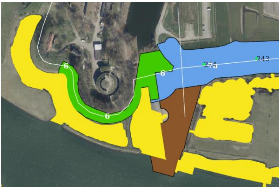
Figuur 5-4 Ligging zoeklocatie tijdelijk depot Fort Honswijk (bruin) en tijdelijk werkterrein (groen) ten opzichte van het ecologisch relevant areaal voor vis (kwalificatie RWS) (geel) binnen dijkvak 6
