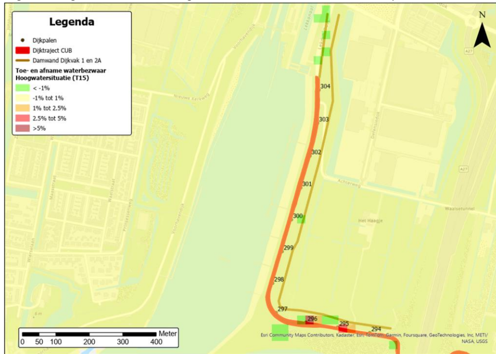
Figuur 6-7 Berekend effect van de damwanden in dijkvakken 1 en 2b op het waterbezwaar
