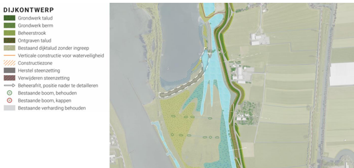
Figuur 3-11 Dijkontwerp dijkvak 5 Weidse dijk, boerderijlint (dijkvak 5a, 5b). Herinrichting uiterwaard is een meekoppelproject
