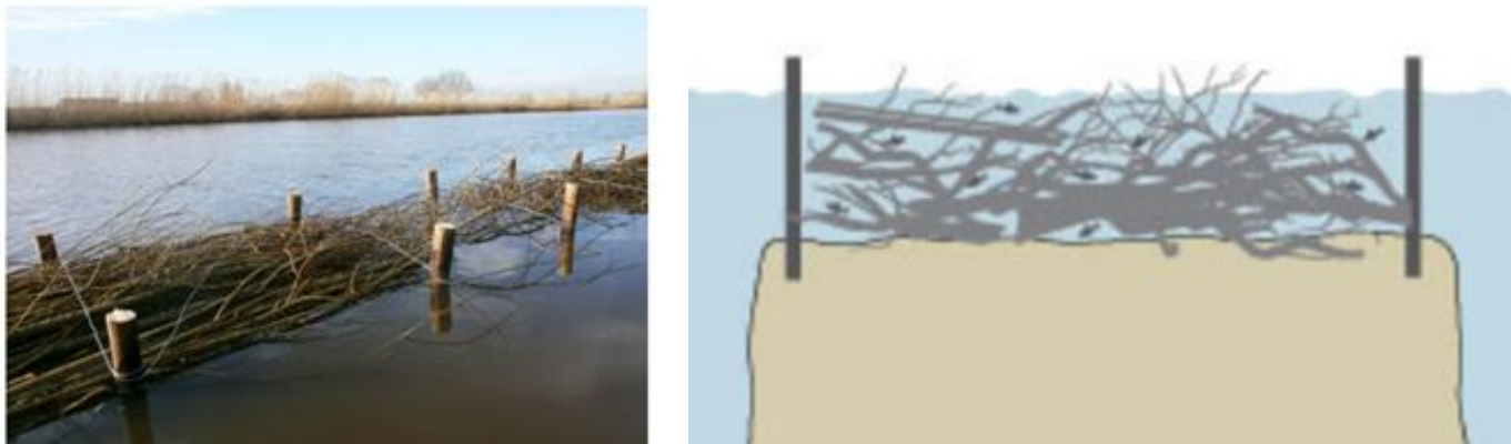
Figuur 5: Voorbeelden van vissenbossen op verzonken lekkers. Beide figuren zijn afkomstig uit Van Helsdingen & Buizer, 2018. Links is een foto van een vissenbos (figuur 4.9 uit voorgenoemde rapport). Rechts geeft een schematische dwarsdoorsnede.
