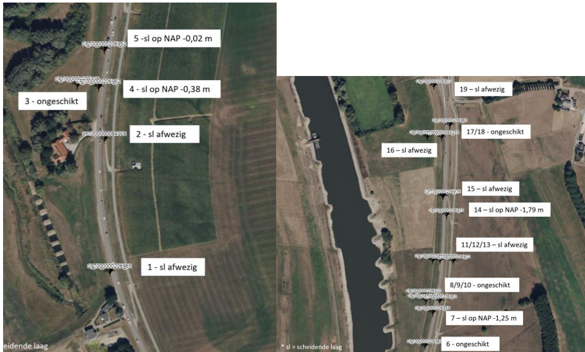
Afbeelding 5.1 Diepte van de scheidende laag (sl) voor Den Elterweg - Zuid (links) en Den Elterweg - Noord (rechts). De onderkant van de damwand ligt in deze trajecten op circa NAP +3 m. De ongeschikte sonderingen zijn niet diep genoeg om de scheidende laag aan te treffen
