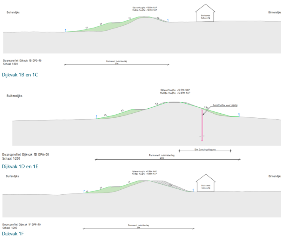
Afbeelding 2.1 Principeprofiel stedelijke dijk
