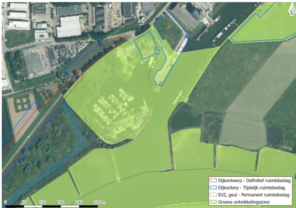
Afbeelding 6.7 Ruimtebeslag in deelgebied 2 door het realiseren van een depot, en de dijkversterking (voor grotere afbeelding zie bijlage II)
