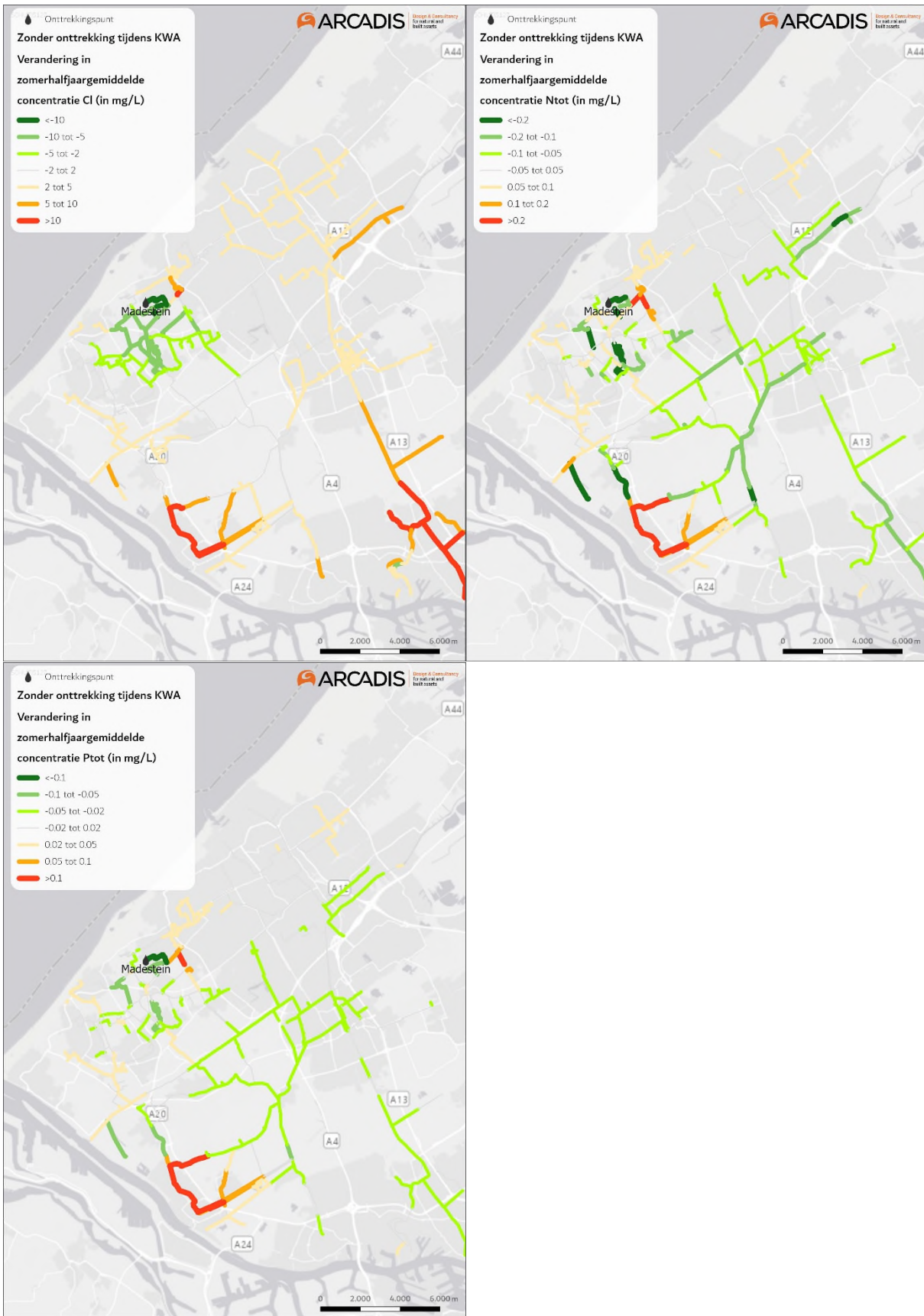
Figuur 7.4 Overzichtskaarten met de uitkomsten van de oppervlaktewaterkwaliteitsmodellering. Met de effecten op chloride, stikstof en fosfor bij een onttrekking in Madestein (locatievariant 1.5) zonder onttrekking tijdens KWA.
