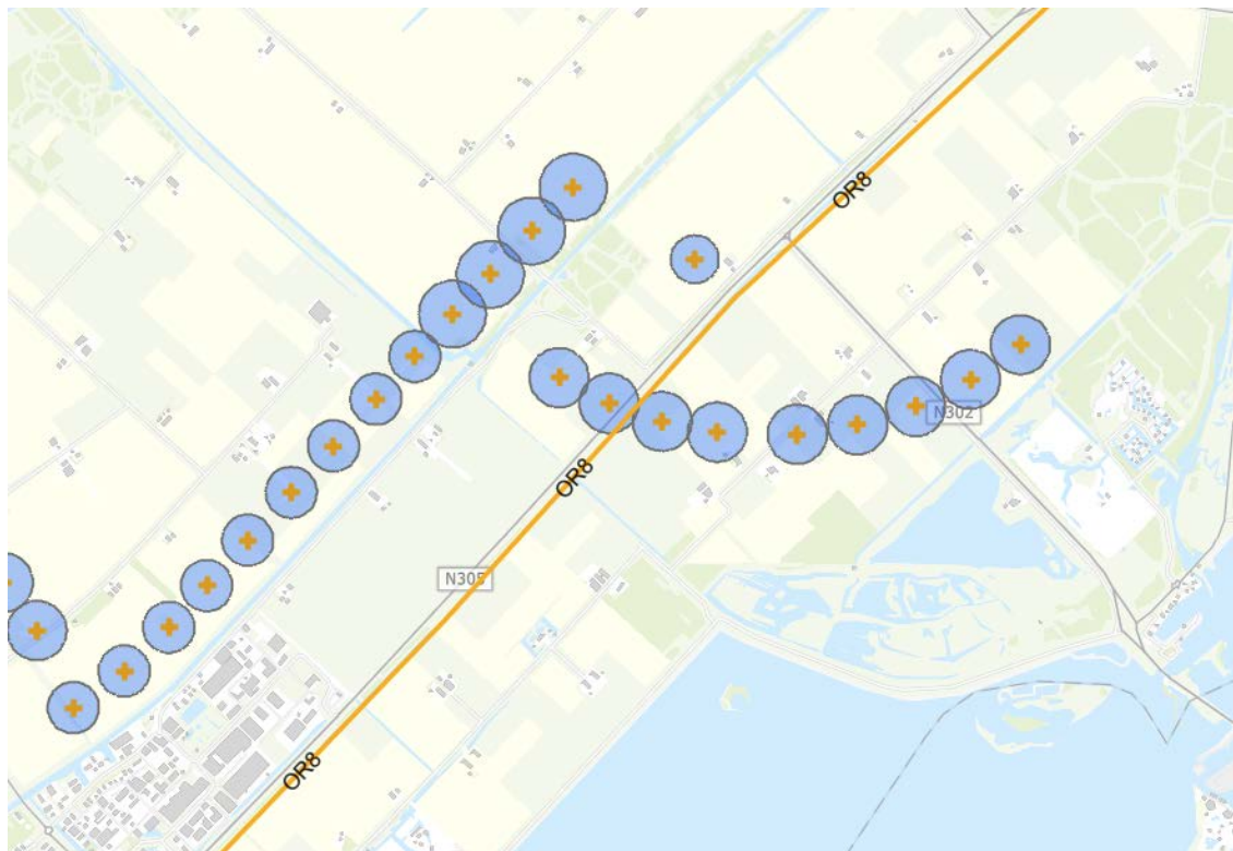
Figuur 5.14 Overzicht van windturbines waarbij de risicocontour overlapt met deeltracé OR8 bij windpark Sternweg en Harderringweg
