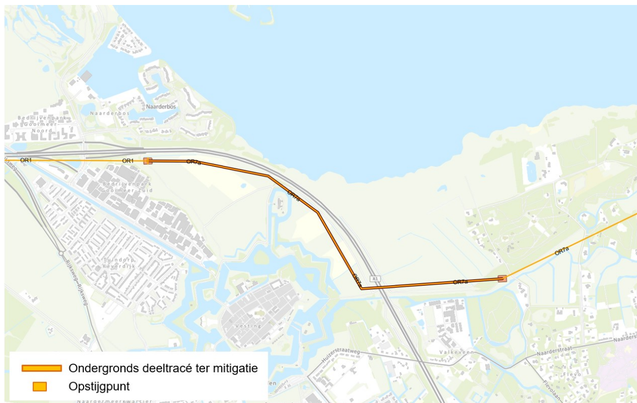
Figuur 8.5 Deeltracé OR7a gedeeltelijk ondergronds nabij Naardervesting vanwege UNESCO Werelderfgoed Hollandse Waterlinies
