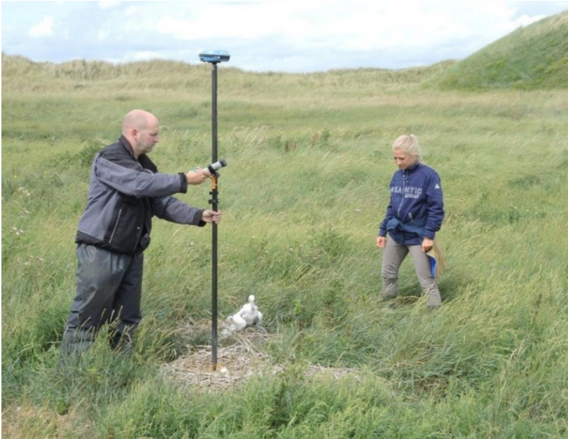
Figuur 5. De XYZ coördinaat van de nestkom van de nesten wordt jaarlijks aan het eind van het broedseizoen ingemeten met een RTK/DGPS apparaat. Op de foto zijn nog enkele late jongen aanwezig. Foto: J. Krol, 12 aug 2013.
