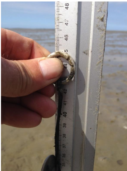
Figuur 6. Meetlijnial met brede meetvoet (niet zichtbaar). Deze wordt steeds op dezelfde wijze op de bodem gezet waarna de lengte van de dyneema lijn langs de schaal wordt afgelezen. In dit geval 45,1 cm.
