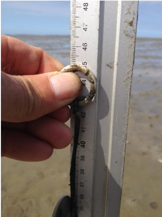
Figuur 6.6 Meetliniaal met brede meetvoet (niet zichtbaar). Deze wordt steeds op dezelfde wijze op de bodem gezet waarna de lengte van de dyneema lijn langs de schaal wordt afgelezen. In dit geval 45,1 cm.
