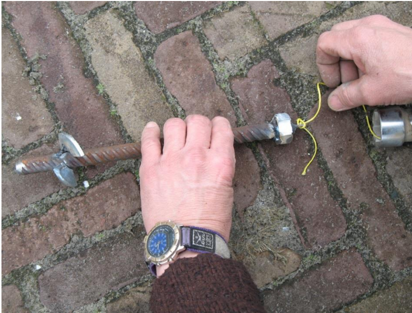
Figuur 6.2 Eigenbouw grondanker waaraan niet rekkend meetouw bevestigd wordt. Rechts de dop aan het uiteinde van de T-grondboor waarmee het anker in de bodem geschroefd wordt (Figuur 6.3).
