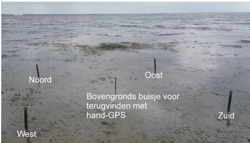
Figuur 6.3 De 4 grondankers die ongeveer 80-100 cm onder het oppervlak worden geschroefd. Hieraan is een dyneema lijn met aan het bovengrondse deel een identificatieblikje en aluminium afleesring bevestigd (Figuur 6.6)
