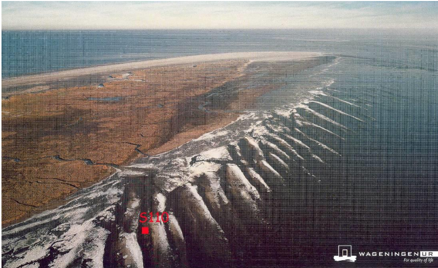
Figuur 6.13 Meetstation S110 op luchtfoto. Zandgolven veroorzaken lokale dynamiek. Na 2010 verdwijnen deze zandgolven en laten de metingen geen hoge pieken en dalen meer zien (Figuur 6.12).
