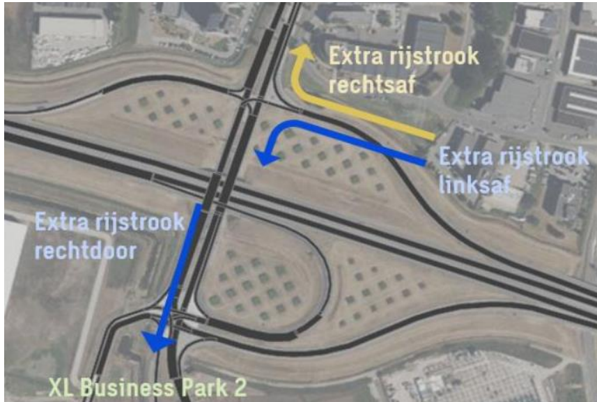
Figuur 8: Mogelijke realisatie extra linksafstrook en rechtdoor rijstrook naar XL Businesspark 2. Bron: Rapportage Verkeersstudie HR Holstlaan Almelo, Sweco.
