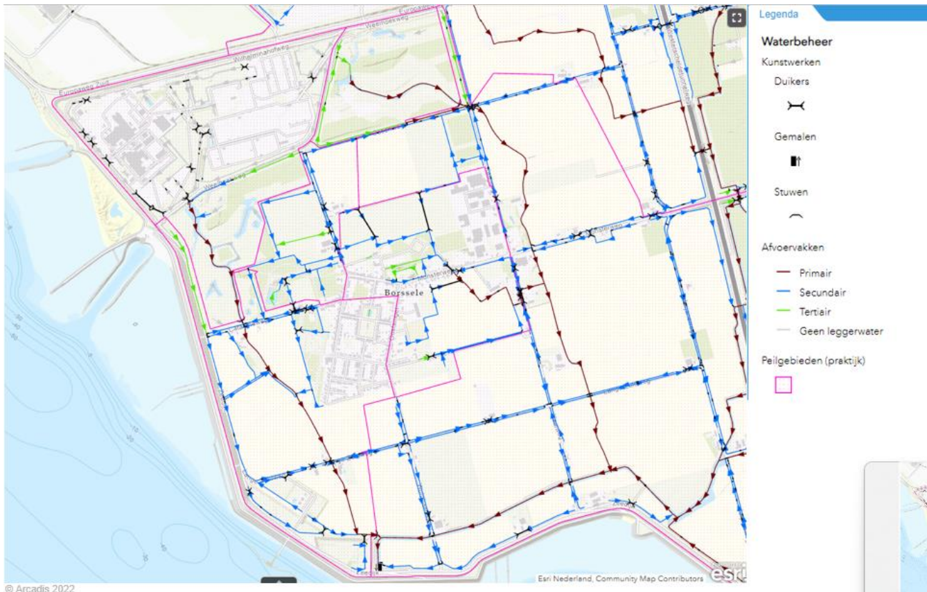
Figuur 9-2 Afwatering van het peilgebied van de kerncentrale Borssele naar oppervlaktewatergemaal Borssele (Waterschap Scheldestromen, 2024)
