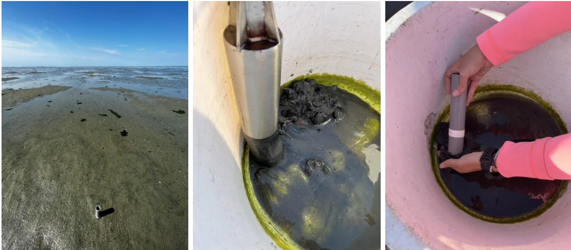
Figuur 2.2. Overzicht van sedimentbemonstering op het wad (links) en aan boord van de RIB (midden en rechts).
