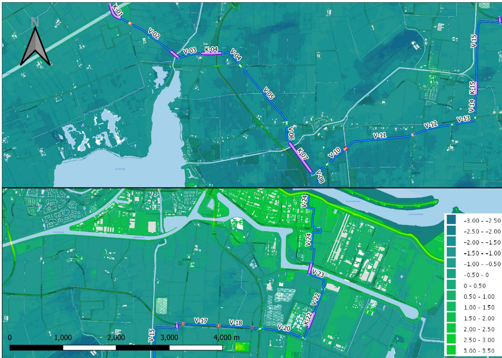
Hoogteligging maaiveld tracédeel Eemshaven-Delfzijl in bovenaanzicht [m NAP]
