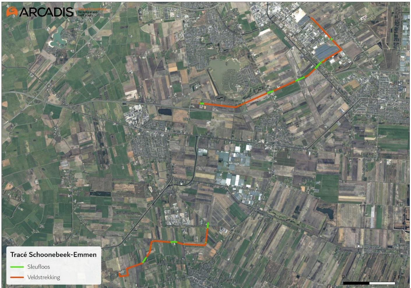
Figuur 2-2 Nieuw aan te leggen tracédelen Schoonebeek en Emmen in provincie Drenthe (sleufloos = gestuurde boring; veldstrekking = open ontgraving)
