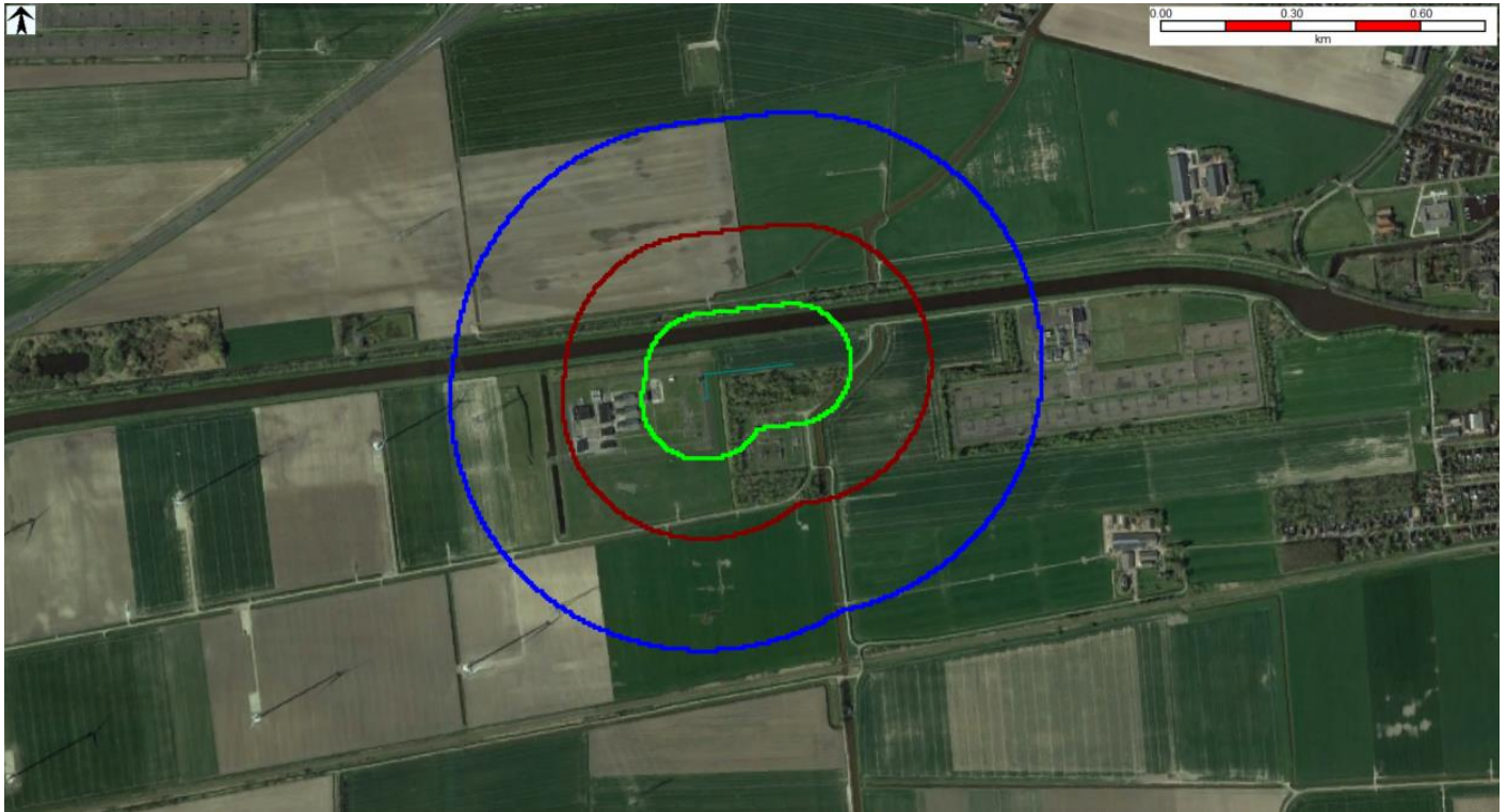
Figuur 8: De warmtestralingscontouren van leiding A-821 KOPPELING.
