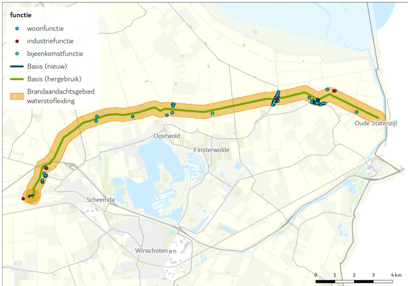
Figuur 4-24: De gebouwen / locaties binnen de brandaandachtsgebieden van de nieuwgebouwde leiding met waterstof en de hergebruikte leiding met waterstof in het deelgebied Scheemda – Oude Statenzijl en de functies van deze gebouwen / locaties.
