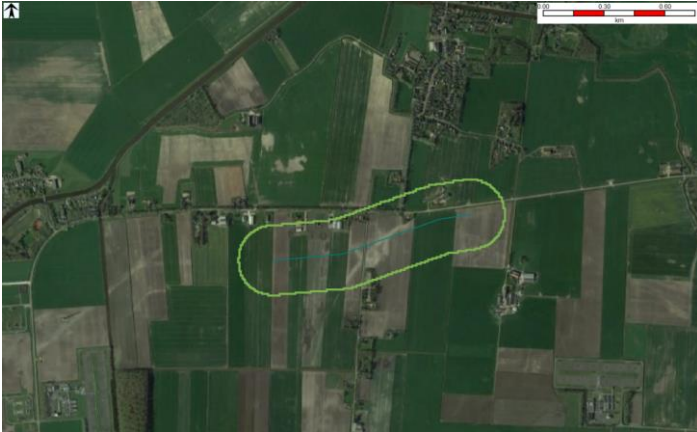
Figuur 4-17: De maatgevende kilometer van de nieuwgebouwde leiding met waterstof in het deelgebied Tjuchem – Delfzijl en het invloedsgebied van deze maatgevende kilometer.
