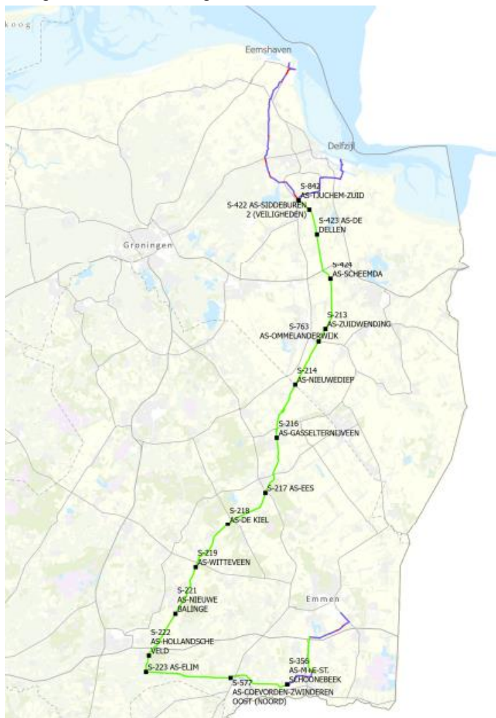
Figuur 1 Ligging tracédeel bestaand (groen), nieuw aan te leggen tracédelen (blauw) en bestaande afsluiters (S-nummers)
