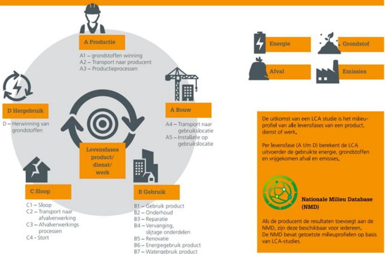
Figuur 1. Visualisatie LCA berekening (bron: stappenplan inkopen met de milieukostenindicator – Pianoo, augustus 2020)
