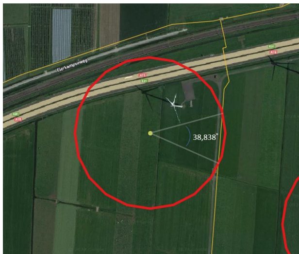
Afbeelding 5.4 Hoek van kruisen effectafstand tot de buisleiding voor de bovengrens (effectafstand van 161 m) 1
