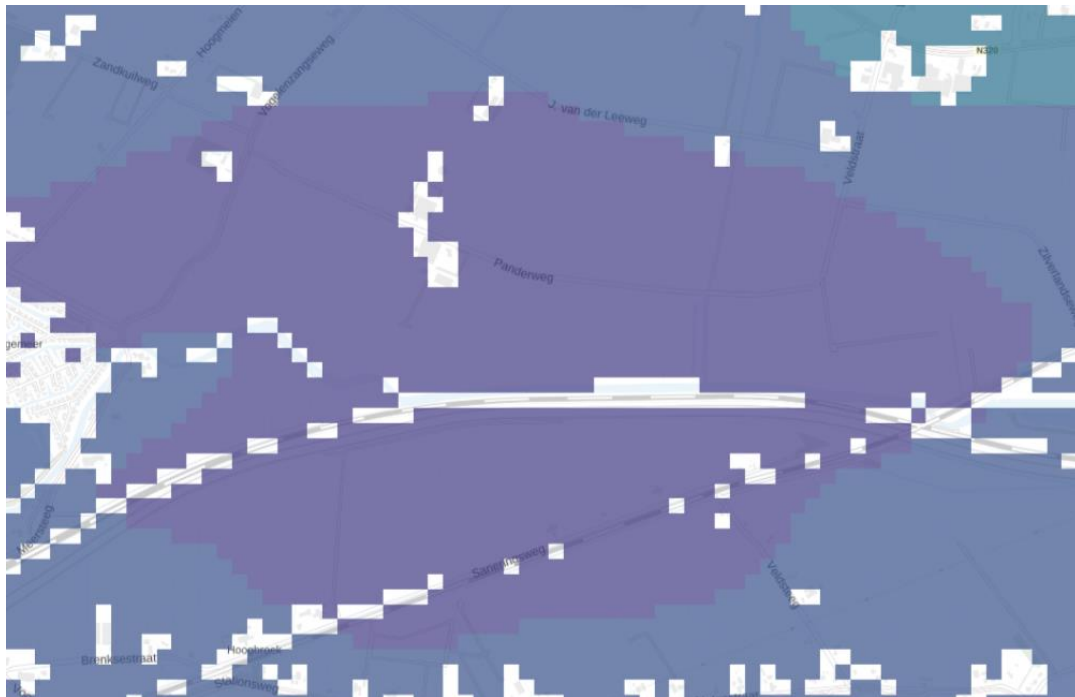
Afbeelding 3.5 Model grondwaterspiegeldiepte van BRO. Donkerpaarse kleur geeft een GHG van 0.45 m-maaiveld en de blauwe kleur een GHG van 0.61 m-maaiveld
