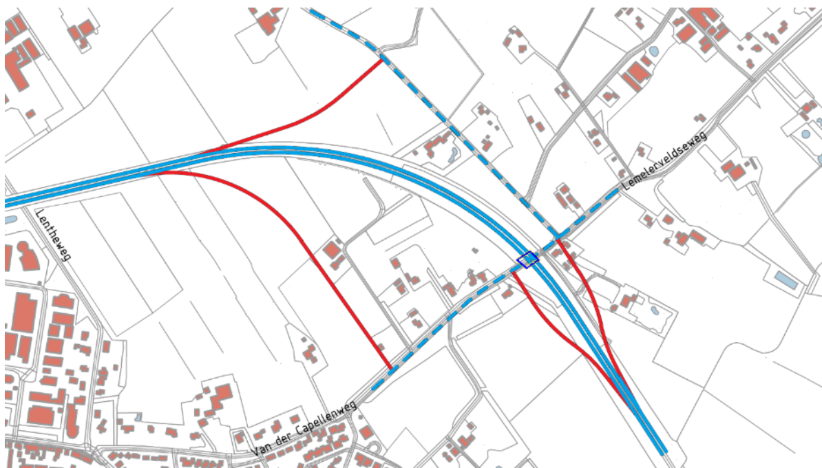
Figuur 59 Schets Lemelerveldseweg – variant L1a ongelijkvloerse Haarlemmermeer aansluiting
