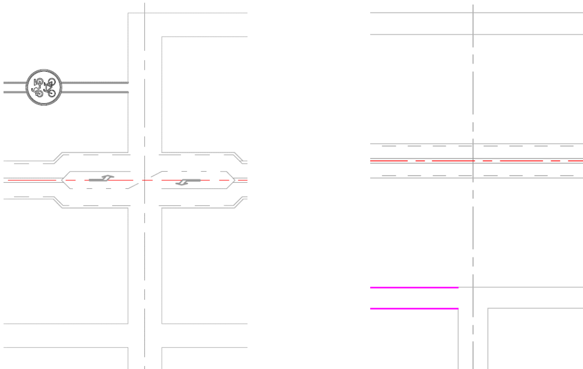
Figuur 82 RijstrookschemaNijverdalseweg hm 25.7 in bestaande situatie (links: voorrangskruispunt) en alternatief 2 (rechts: opheffen kruispunt)
