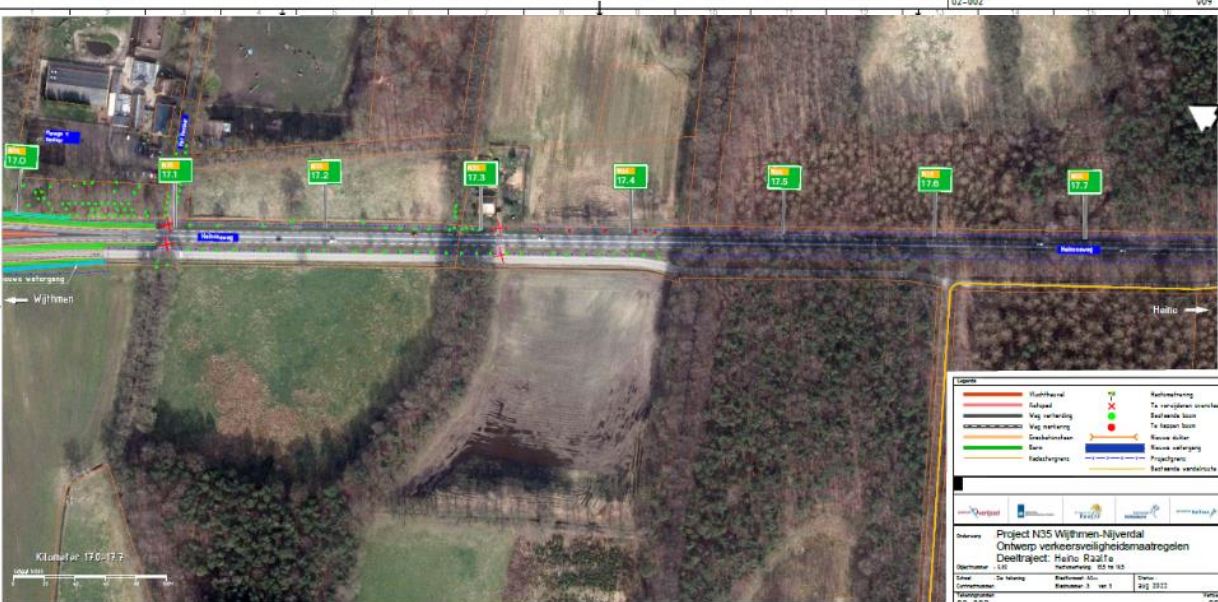
Figuur 68 Te realiseren bajonetkruispunt Heino-Raalte vanuit project N35: Verbeteren verkeersveiligheid Wijthmen-Nijverdal (Programma Meer Veilig 3)
