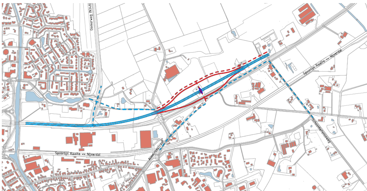
Figuur 75 Schets N348 Ommerweg/Almelosestraat – variante AO2 kruising N348 Ommerweg met verkeerslichten en aansluiting Almelosestraat ongelijkvloers
