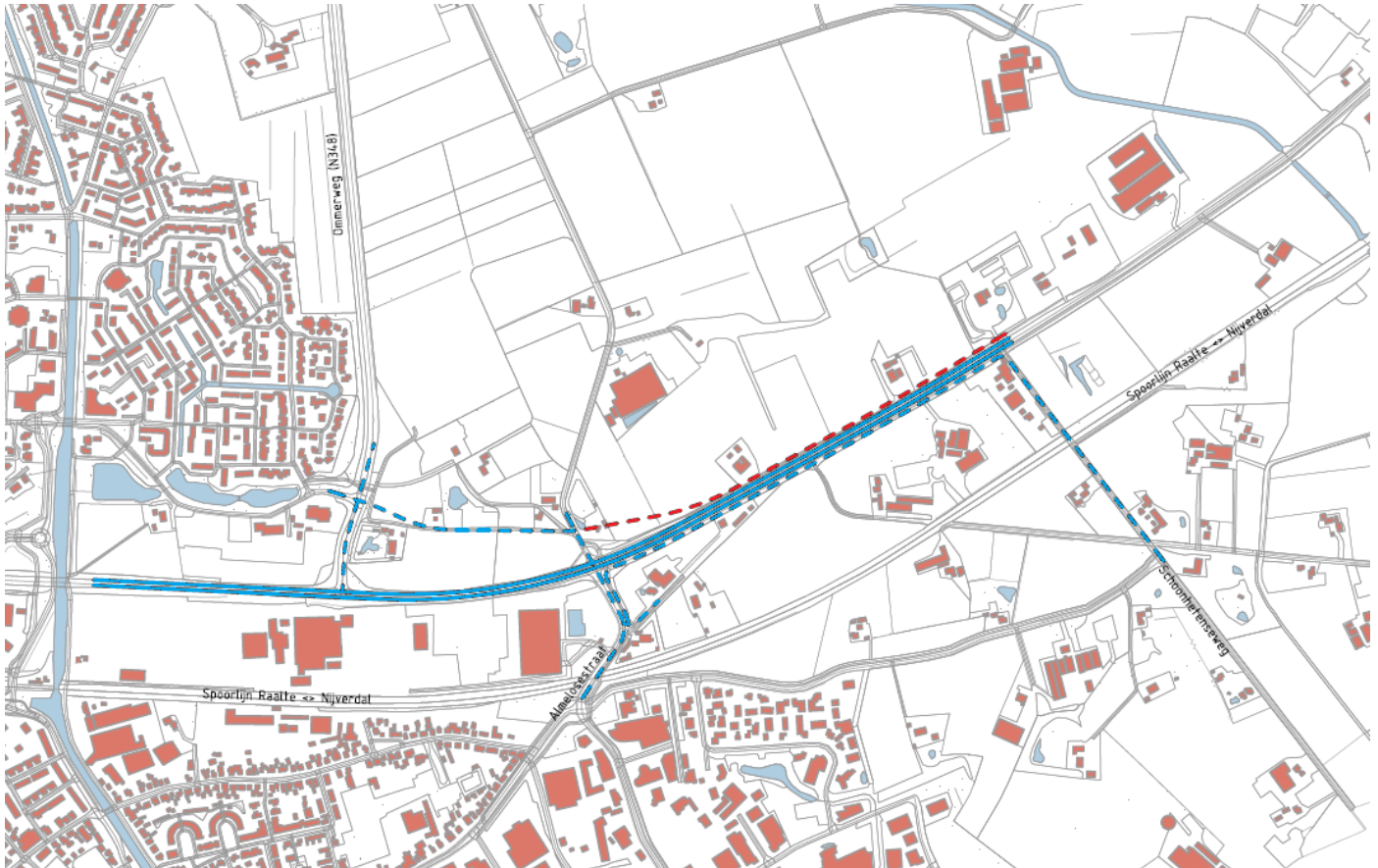
Figuur 79 Schets N348 Ommerweg/Almelosestraat – variant AO3, twee met verkeerslichten geregelde kruispunten
