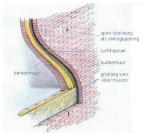
Ingemetselde geschakelde inbouwkasten voor vleermuizen en vleermuisvriendelijk isolatiemateriaal (met grip). Brochure 'Vleermuisvriendelijk bouwen', Zoogdierverseniging.
