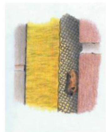
Ingemetselde geschakelde inbouwkasten voor vleermuizen en vleermuisvriendelijk isolatiemateriaal (met grip). Brochure 'Vleermuisvriendelijk bouwen', Zoogdierverseniging.
