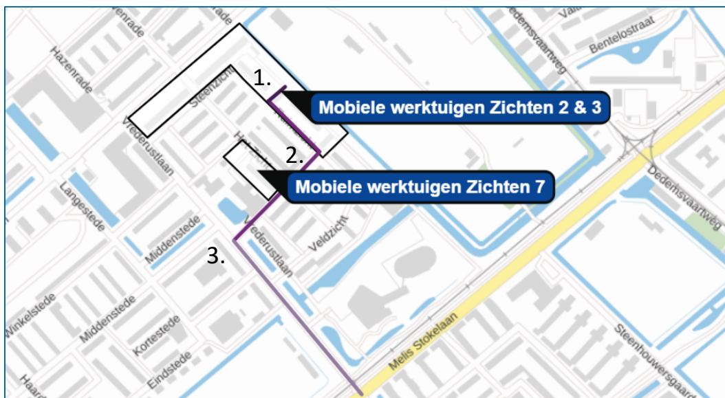
Figuur 6. Ligging van de gemodelleerde bronnen tijdens de realisatiefase. De snelheid is binnen de bebouwde kom, met stagnerend verkeer bij wegbron 1, normaal verkeer bij 2 en doorstromend verkeer bij 3. Zie de kleuren paars (AERIUS, 2023)
