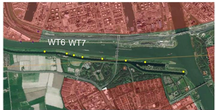
Figuur 12-3 Zichtlijnen (precieze locatie radar t.o.v. windturbines) gevechtsleidingradar locaties Goudriaan en Meerkerk (oranje lijn horizontaal door het figuur laat zichtlijn van de radarlocatie zien. De lijn overlapt met de twee windturbines aan weerszijde van de N218 (WT 6 en 7))
