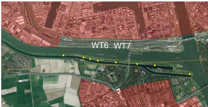
Figuur 12-3 Zichtlijnen (precieze locatie radar t.o.v. windturbines) gevechtsleidingradar locaties Goudriaan en Meerkerk (oranje lijn horizontaal door het figuur laat zichtlijn van de radarlocatie zien. De lijn overlapt met de twee windturbines aan weerszijde van de N218 (WT 6 en 7))
