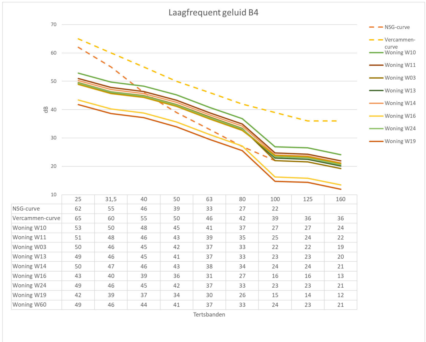
Figuur 8-34 Berekende lineaire binnenniveaus op kritische woningen versus NSG-curve en Vercammen-curve B4.1
