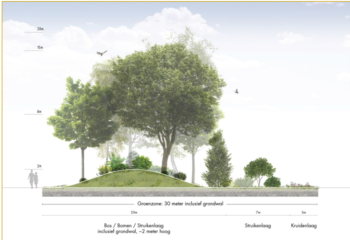
Principedoorsnede noordelijke randzone inclusief te beplanten grondwal
