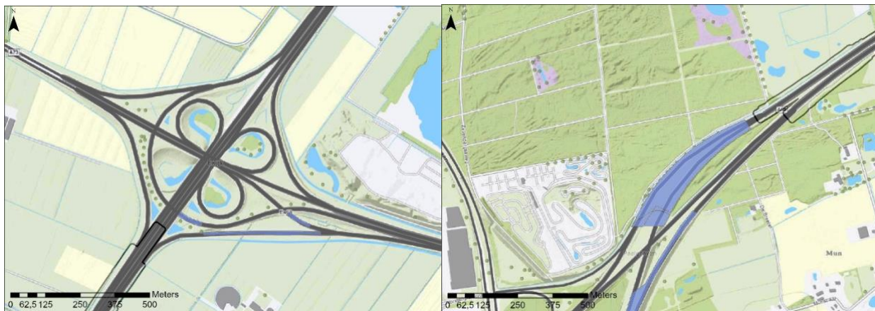
Figuur 8.2.2.1: Knooppunt Ewijk en Paalgraven met de contouren waar AVI-bodemas is toegepast (paars) en de contour van het plangebied (zwart)
