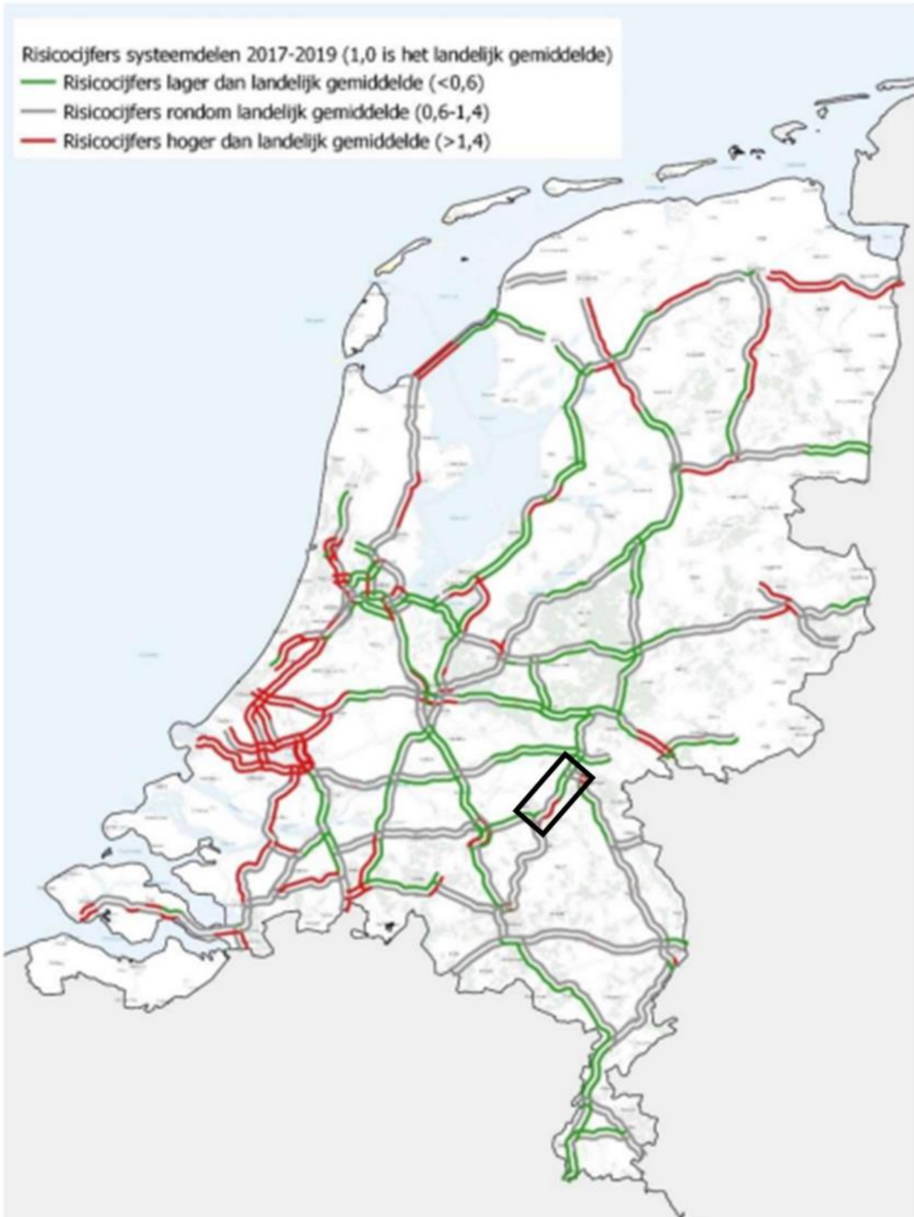
Figuur 5 Risicocijfers systeemdelen autosnelwegen 2017-2019 (RWS, 2020)
