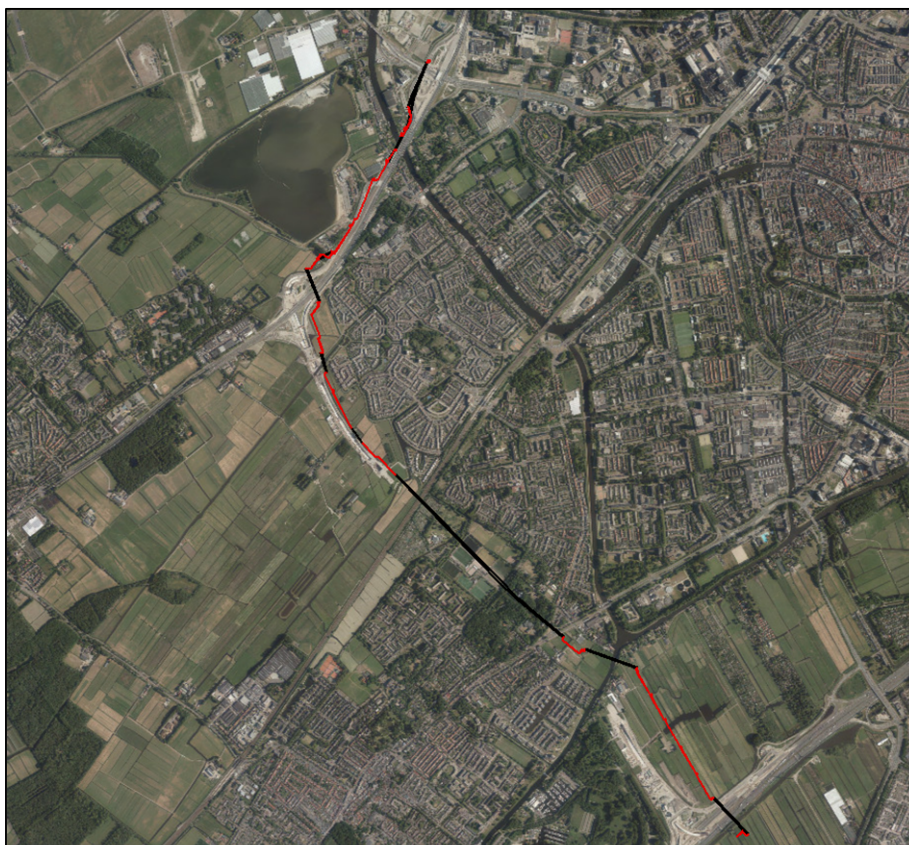
Figuur 1.2: Ligging tracé met aanleg in open ontgraving (rood) en met sleufloze technieken (zwart). Bron achtergrond: ESRI luchtfoto, 2020
