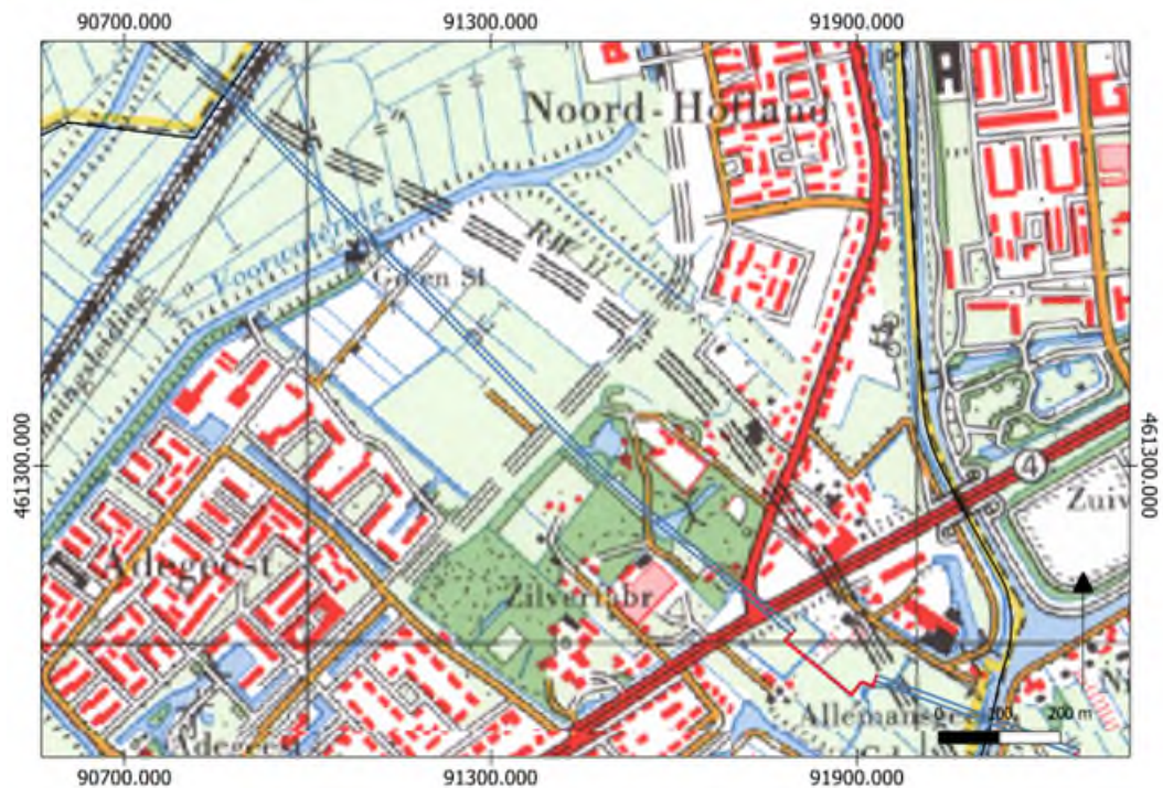
Afbeelding 11. Het plangebied op de topografische kaart van 1980. Aanleg door middel van open ontgraving = rode lijn, aanleg door middel van sleufloze technieken = blauwe lijn. (bron: www.topotijdreis.nl ).
