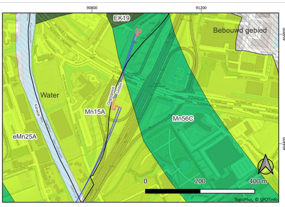
Afbeelding 20. Uitsnede van de bodemkaart van Nederland met het plangebied, deelgebied 2. Aanleg door middel van open ontgraving = rode lijn, aanleg door middel van sleufloze technieken = blauwe lijn.
