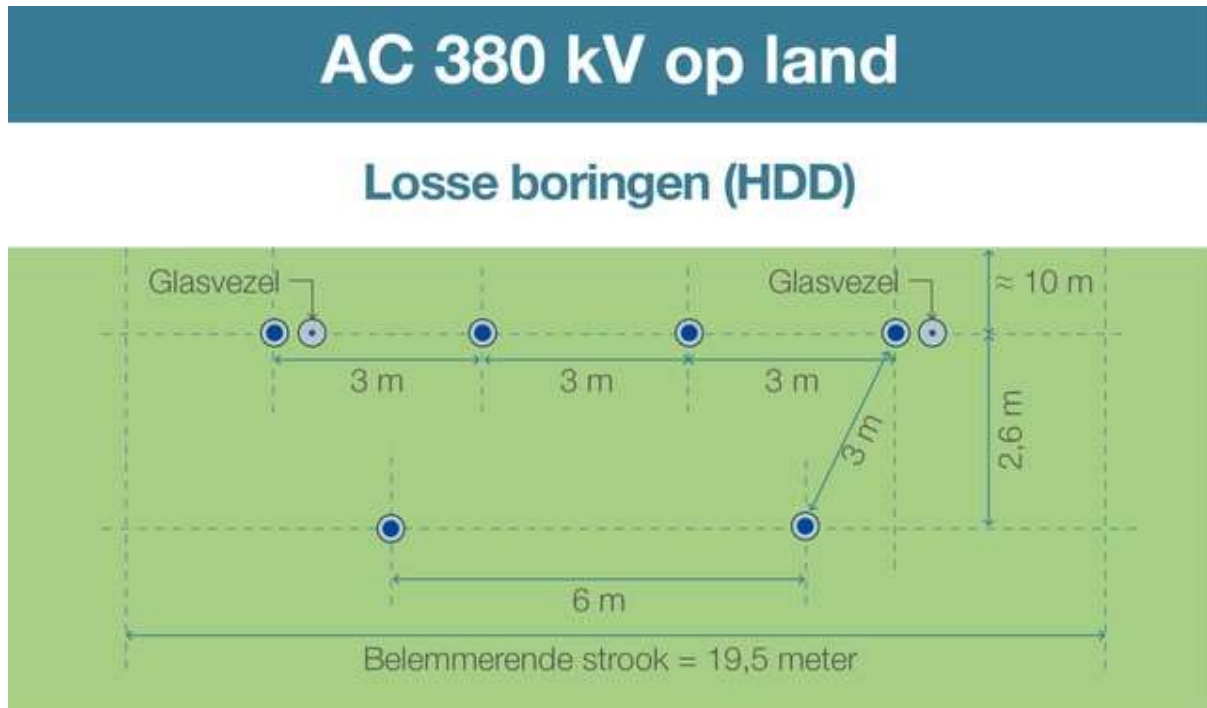
Figuur 2-23 Kabelconfiguratie AC-verbinding bij boring (HDD).
