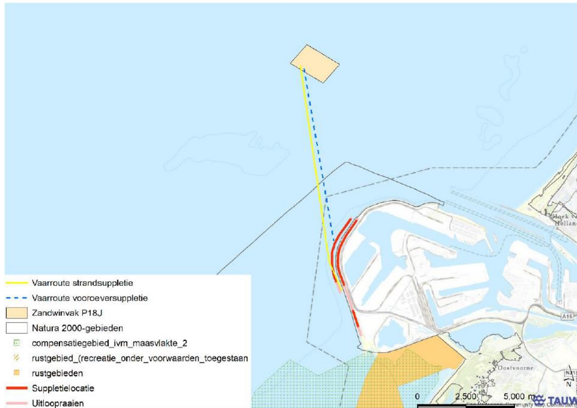
Figuur 4-7 Zandwinninglocaties en suppletielocaties voor onderhoud de Tweede Maasvlakte. Overgenomen uit (Tauw, 2021).
