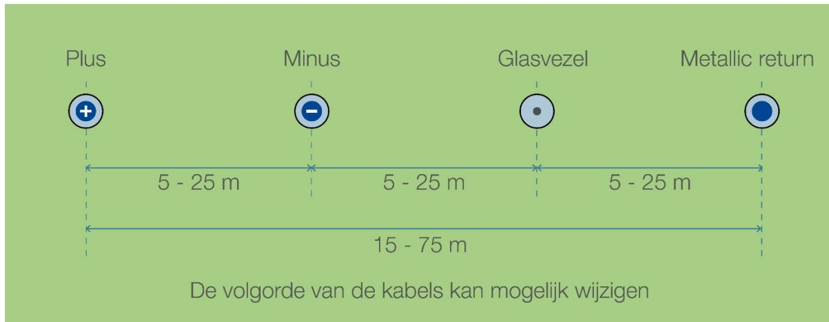
Figuur 1-21 Kabelconfiguratie aanlanding Tweede Maasvlakte
