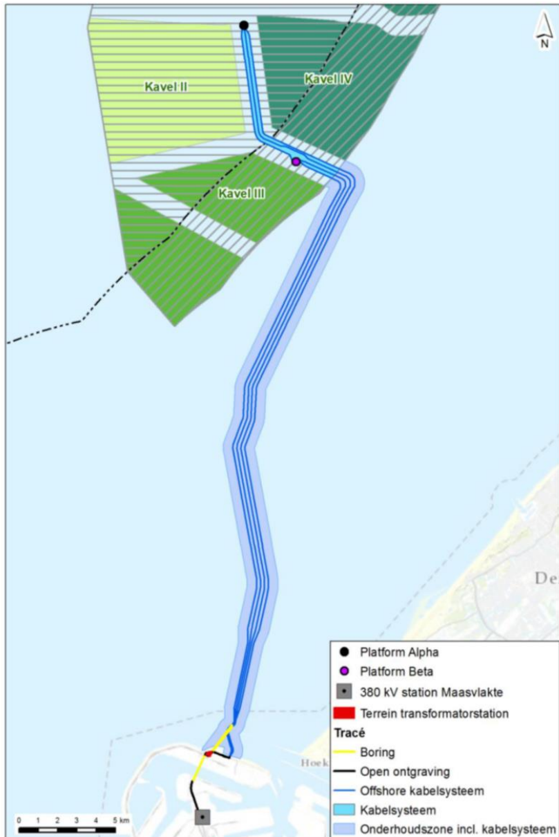
Figuur 1-30 Kavels windgebied Hollandse Kust (zuid) en kabeltracé Net op zee Hollandse Kust (zuid)
