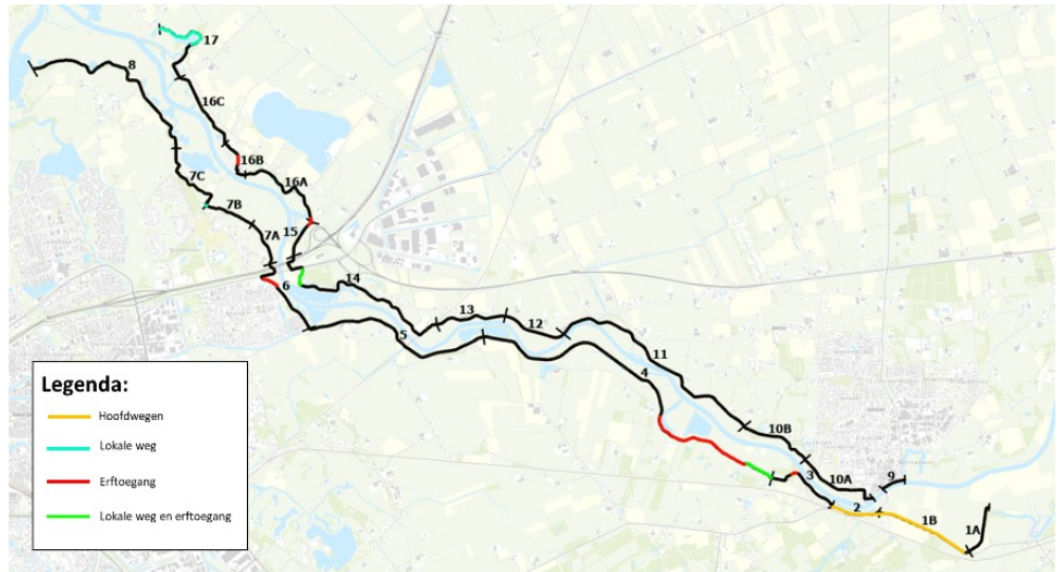
Afbeelding 4-15 Overzicht van locaties waar de dijk onderdeel uitmaakt van de weginfrastructuur of de enige toegangsmogelijkheid vormt voor een erf/woning.
