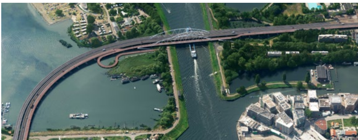
Alternatief 2. Extra fietsbrug en trambrug (doorvaarthoogte 9,10m)
