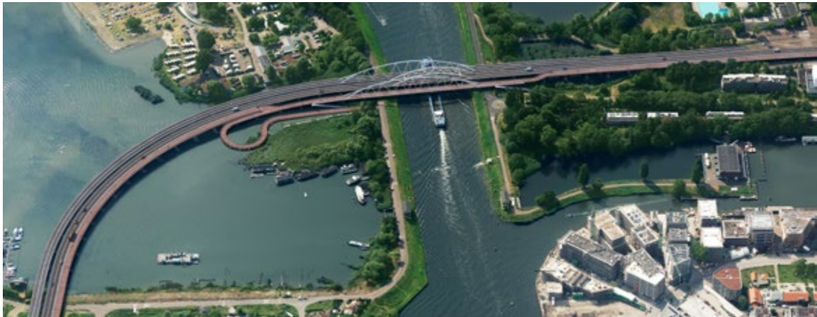
Figuur 6. Weergave alternatief 2, als aanvulling op de maatregelen in alternatief 1 wordt aan de andere kant van de Amsterdamsebrug een trambrug gerealiseerd. Alle bruggen komen op de hoogte van de bestaande brug (9,10 meter)
