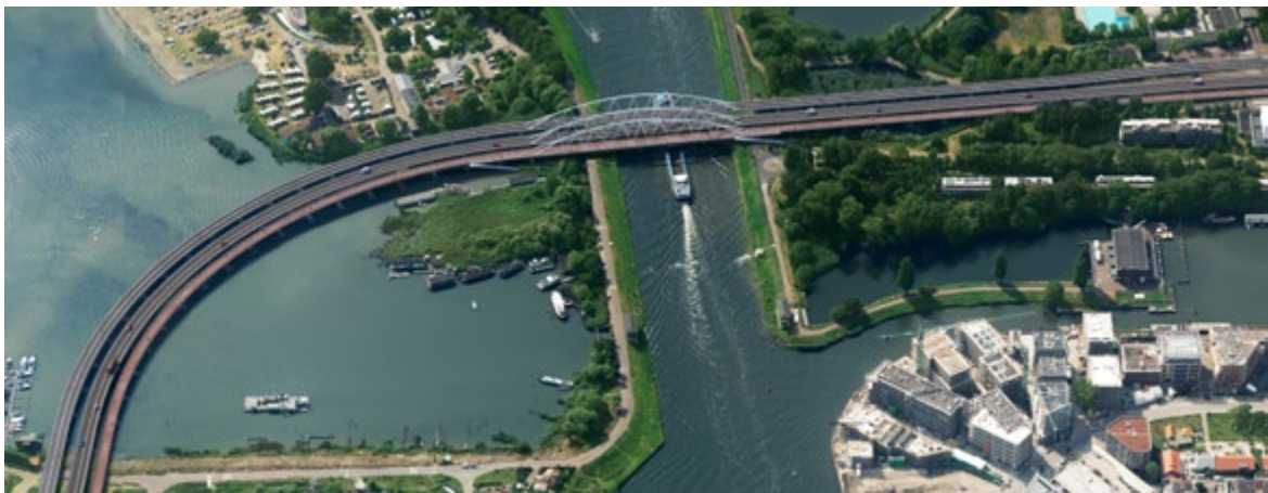
Figuur 7. Weergave alternatief 3, in dit alternatief komen de nieuwe fietsbrug, een nieuwe Amsterdamsebrug en de trambrug hoger te liggen (op 11,35 meter). Vanwege de hoogte van de brug wordt een eventuele fietslus naar de Zuider IJdijk zo lang dat hij geen toegevoegde waarde heeft. Een fietslus is daarom geen onderdeel van dit alternatief.
