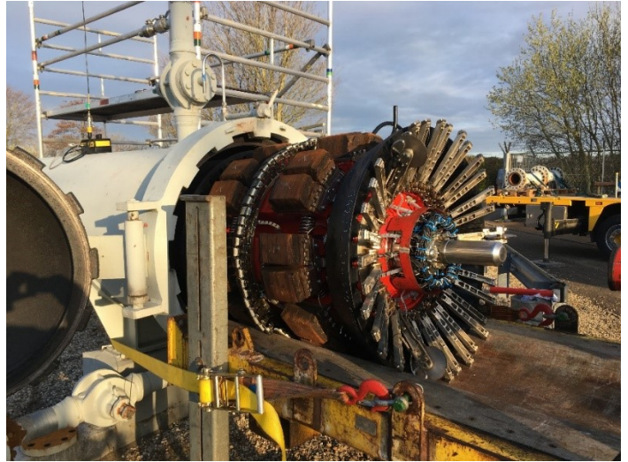
Figuur 3-2 Voorbeeld van pigfaciliteit (links). Bovengronds kan de pig worden ingebracht en wordt via de pigfaciliteit naar de ondergrondse leiding geleid. Rechts wordt het inbrengen van een pig weergegeven.
