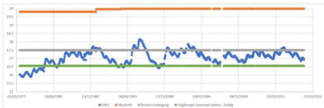
Figuur 3-7: Verloop grondwaterstand in peilbuis B39F0224 t.o.v. de stijghoogte in het bepompte pakket, de bodemhoogte en maaiveldhoogte
