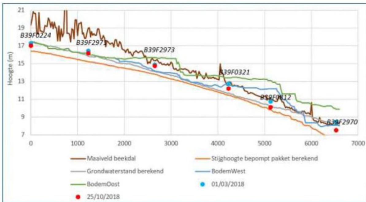
Figuur 3-5: Lengteprofiel Renkums beekdal. De punten geven gemeten grondwaterstanden weer. De lijnen berekende stijghoogtes in de huidige situatie
