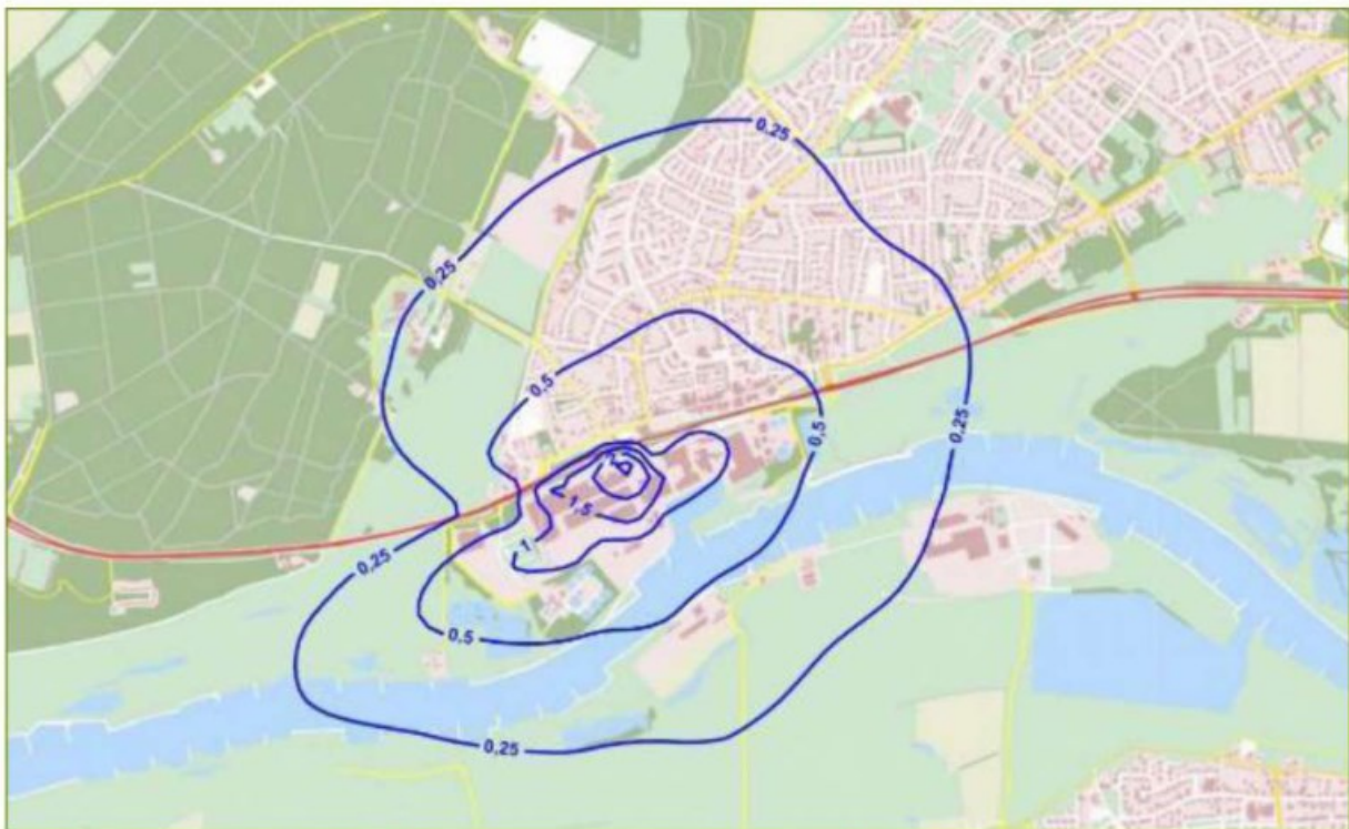
Figuur 4.7: Geurbelasting (enkel) PM1 als geurcontouren in \mu\text{g}/\text{m}^3 als 98-percentiel – Alt2+
