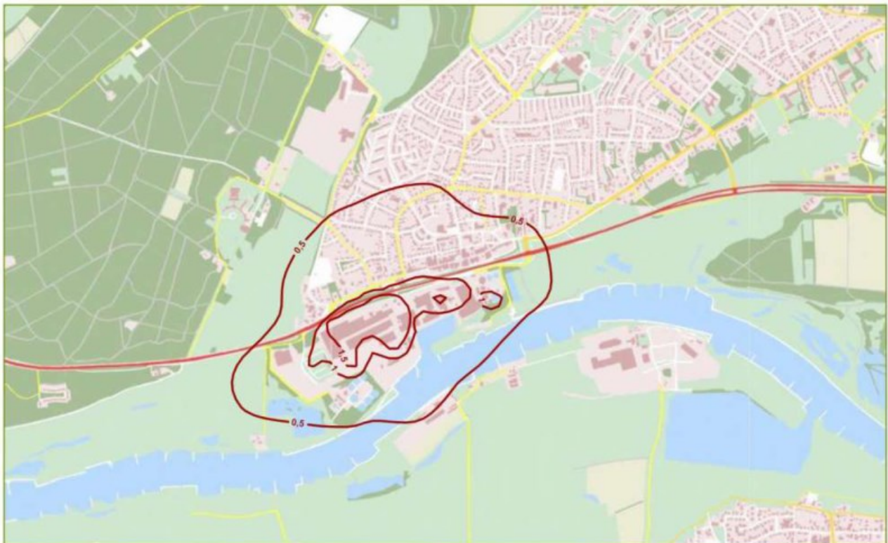
Figuur 4.2: Geurbelasting SK Parencó als geurcontouren in ou_E/m^3 als 98-percentiel – Alt1+
