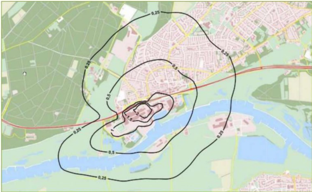
Figuur 4.6: Geurbelasting (enkel) PM1 als geurcontouren in \mu\text{g}/\text{m}^3 als 98-percentiel – Alt2
