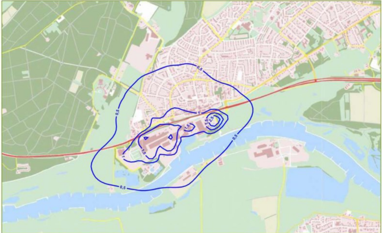
Figuur 4.1: Geurbelasting SK Parencó als geurcontouren in ou_E/m^3 als 98-percentiel – Alt1
