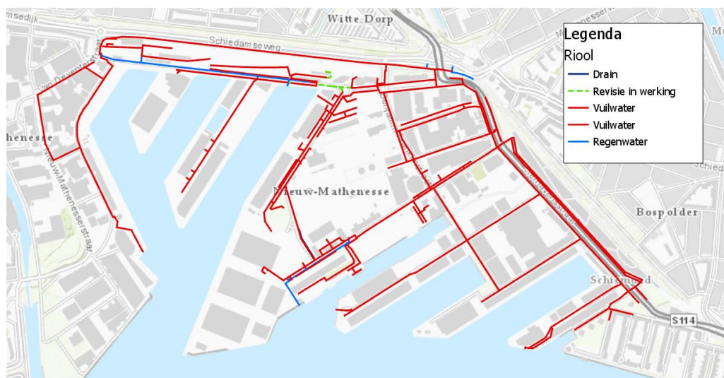
Figuur 14-7: Riolering M4H (bron: Gemeente Rotterdam).
