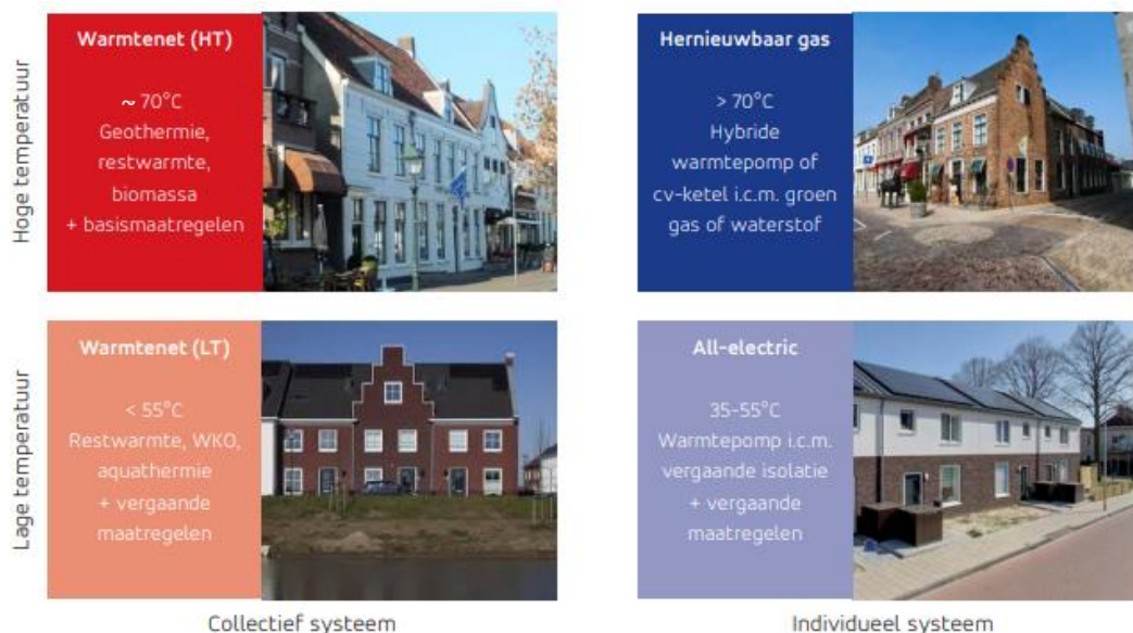
Figuur 6.18 Verschillend duurzame warmtebronnen in relatie tot de temperatuurlevering (bron: Transitievisie warmte).
