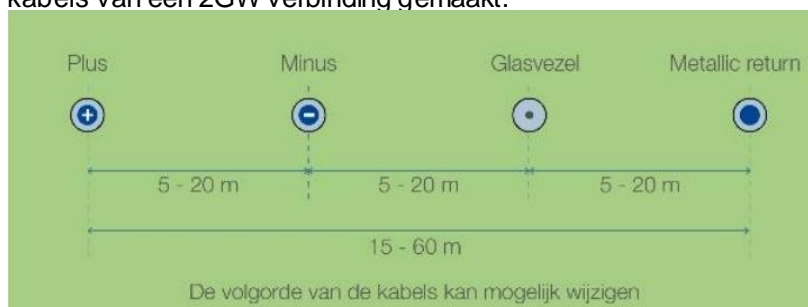
Afbeelding 31b. Een 2 GW-kabelsysteem HDD-kruising primaire waterkering
