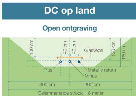
Afbeelding 3.5 Dwarsdoorsnede DC-verbinding op land
