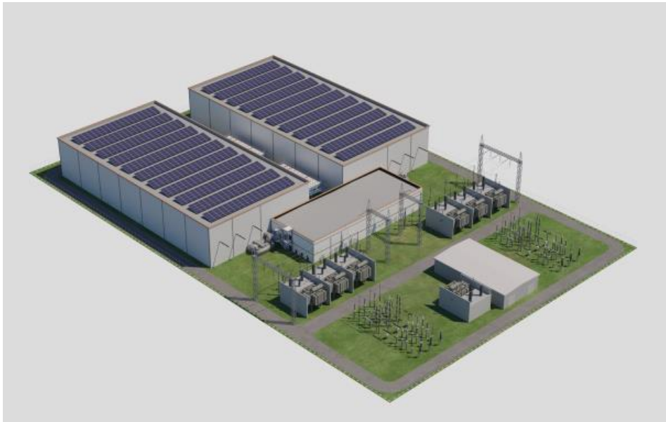
Afbeelding 35. Indicatieve weergave van een converterstation (2 GW)
