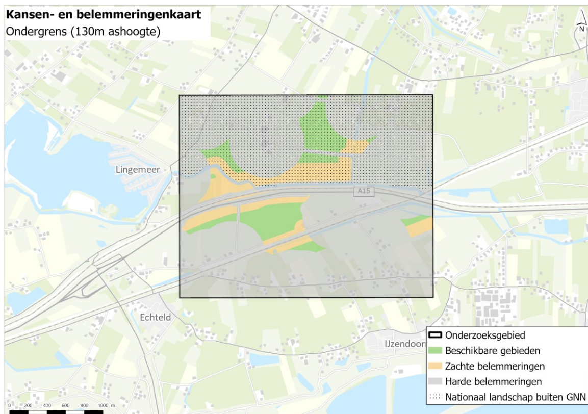
Afbeelding 2.6 Plaatsingszone 130 m windturbine
