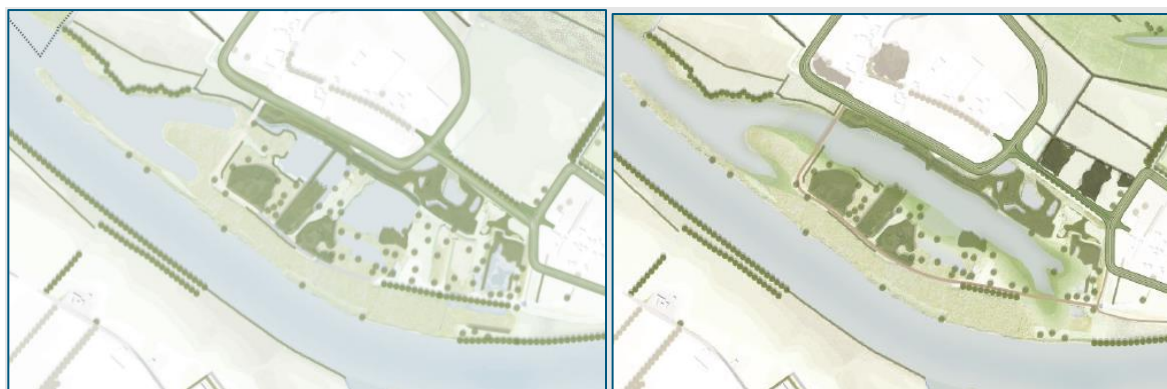
Figuur 2-5: Rivierverruiming in De Band; links de huidige situatie, rechts de situatie met verruiming
